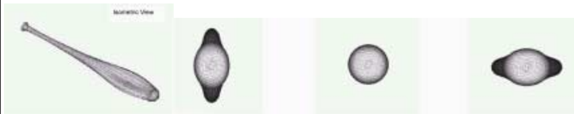
รูปที่ 4 รูปแบบการสั่นสะเทือนในแนวรอบทรงกระบอก (barrel mode)
